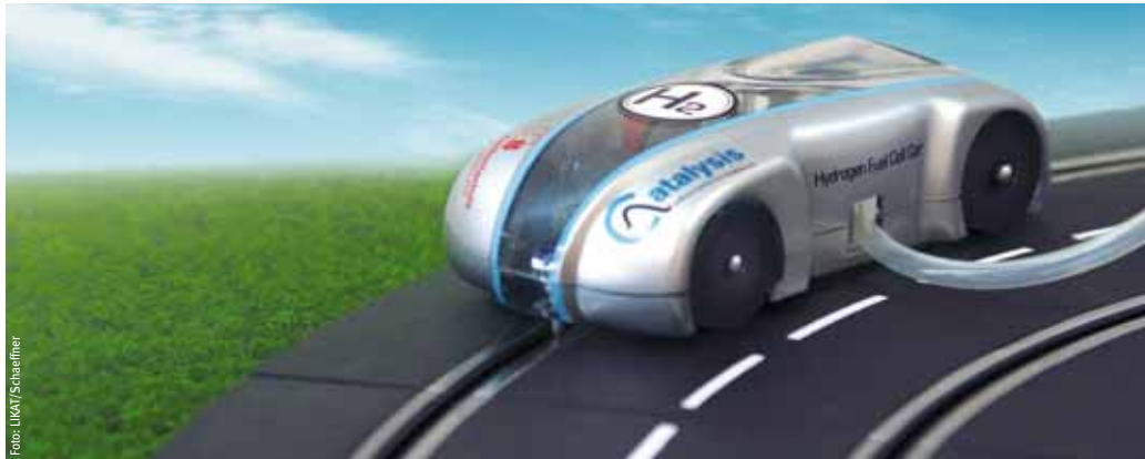
Photo: Ulfert/Schäffner Noch fährt damit nur ein Modellauto, doch in wenigen Jahren wollen die Forscher des Rostocker Leibniz-Instituts für Katalyse größere technische Geräte betreiben: Dank aus Ameisensäure kostengünstig erzeugter Wasserstoff.
